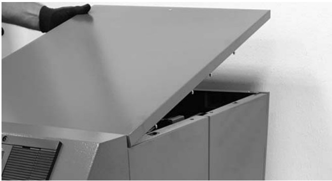
Abb. 79: Demontage der oberen Verkleidung
