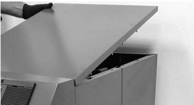
Abb. 26: Demontage des Verkleidungsdeckels
