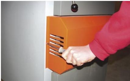
1 Die beiden Schrauben der Druckgebläseabdeckung lösen und Gebläseträgerbaugruppe abnehmen.
