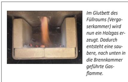
Im Glutbett des Füllraums (Vergaserkammer) wird nun ein Holzgas erzeugt. Dadurch entsteht eine saubere, nach unten in die Brennkammer geführte Gasflamme.
