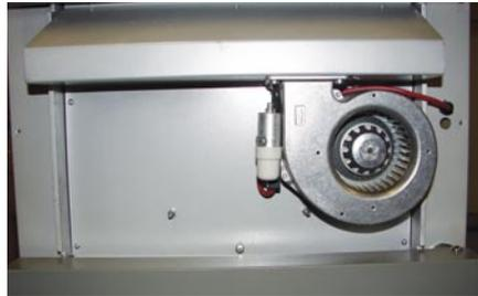
2 Ausstecken der Elektroleitungen. Schrauben der Gebläseträgerbaugruppe lösen und das Blech samt Druckgebläse abnehmen. Bei der Wiedermontage darauf achten, dass die Dichtung sauber anliegt.
