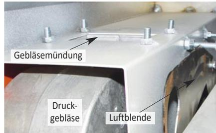
Die Position der Luftblende wird vom Stellmotor selbstständig gefunden, wobei die beiden Endpositionen durch die Anschlagsschrauben vorgegeben sind.
