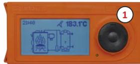
Grafisches Display mit vordefiniertem Solarbayer-Hydraulikschema.
